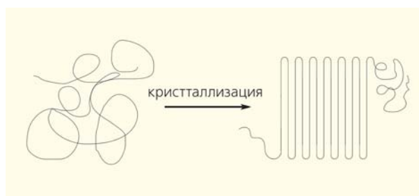
Рис.13. Схема кристаллизации полимера путем складывания индивидуальных цепей.
