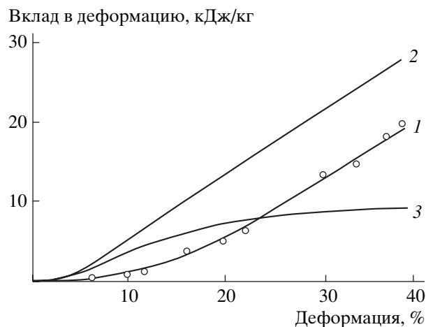
Рис. 7. Зависимость теплоты (1), механической работы (2) и запасенной внутренней энергии (3) от величины деформации одноосного сжатия ПС при 30°C и скорости деформации 5 \times 10^2 \text{ мин}^{-1} [29].
